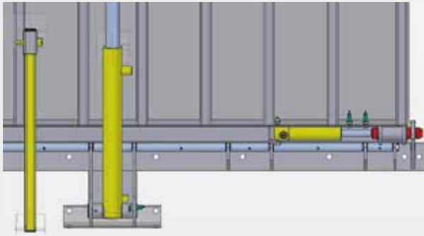
Passerelle en position de repos, avec dispositif de sécurité activé pour éviter toute chute accidentelle de celle-ci.
