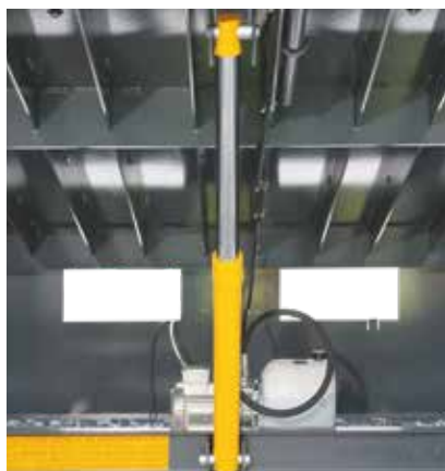
Vérin de levage avec vanne anti-chute.
