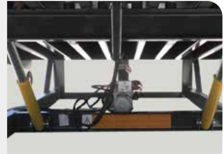
Vérins de levage avec soupape de sécurité
