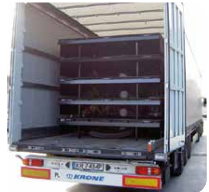
Il permet de placer cinq machines en colonne à l'intérieur d'un camion conventionnel.
