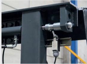
Boulon de sécurité de la rampe
