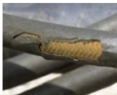
Daño visible cubierta Reemplazo inmediato
