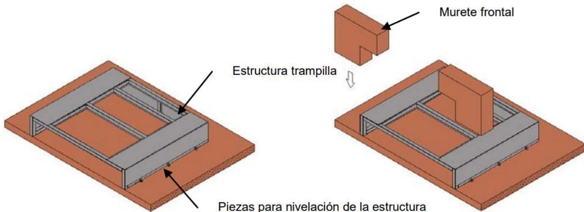
Una vez fijado y nivelado el encofrado perdido, y terminado el murete frontal, realizaremos la aportación de las tierras a compactar. La compactación de tierras se realizará SOLO hasta el nivel de la estructura de la trampilla.
