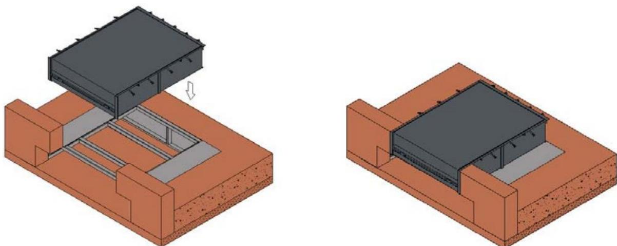
Colocar el tubo de Ø50, para las conducciones eléctricas. Prever cable guía por el tubo o bien directamente pasar los cables de la rampa por el tubo. Sacar el tubo del suelo, al pie de donde va ir situado el cuadro eléctrico, y terminar la aportación de tierras y la compactación de las mismas.
