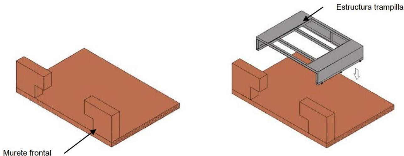
Una vez fijado el encofrado perdido realizaremos la aportación de las tierras a compactar. La compactación de tierras se realizará SOLO hasta el nivel de la estructura de la trampilla.
