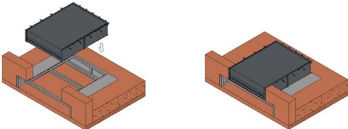
Colocar el tubo de Ø50, para las conducciones eléctricas. Prever cable guía por el tubo o bien directamente pasar los cables de la rampa por el tubo. Sacar el tubo del suelo, al pie de donde va ir situado el cuadro eléctrico, y terminar la aportación de tierras y la compactación de las mismas.
