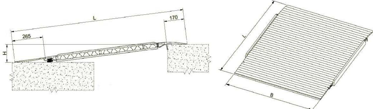
Passerelle PA54 avec système de renfort (R) :
