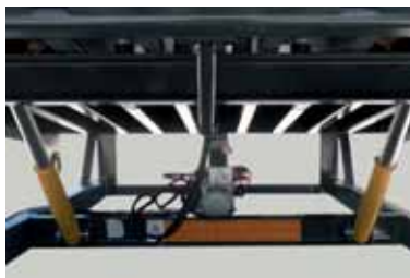
Les RH2 et RH3 possèdent deux vérins de levage avec une tige de 50mm de Ø.
