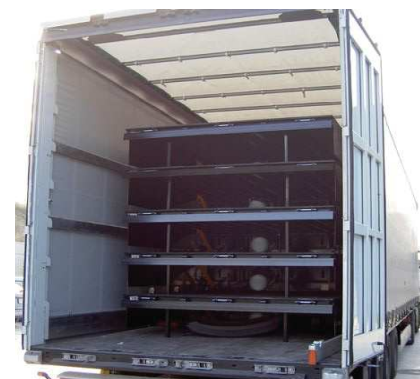
Permite encajar 5 máquinas en columna dentro de un camión convencional.
