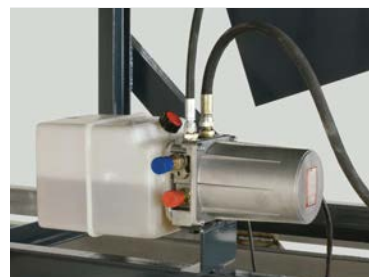
Centralita hidráulica de la RH13
