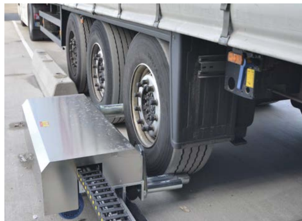
Sistema inmovilizador manual de vehículos adaptable a la mayoría de camiones.
