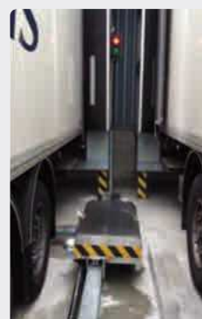
Inicio de desbloqueo. Semáforo rojo intermitente en rojo.
