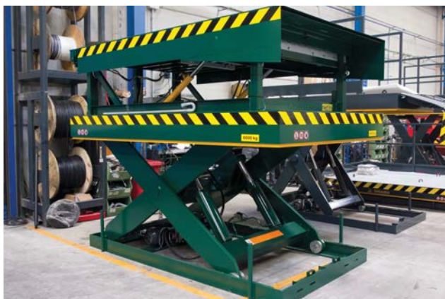
Mesa elevadora Dual con labio retráctil de 500mm.
