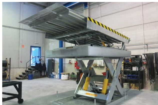
Mesa elevadora Dual galvanizada con labio retráctil de 1.000mm.
